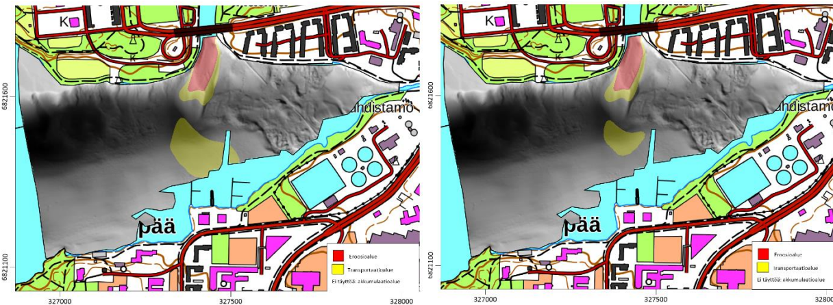
Kuva 34. Virtaamien synnyttämät eroosioalueet (punainen) ja transportaatioalueet (keltainen) keskivirtaama+keskituuliskenaariossa. Vasen: nykytila, oikea: tuleva tilanne. Nykytilanne on leikattu tulevan rantaviivan kohdalta vertailun helpottamiseksi.
